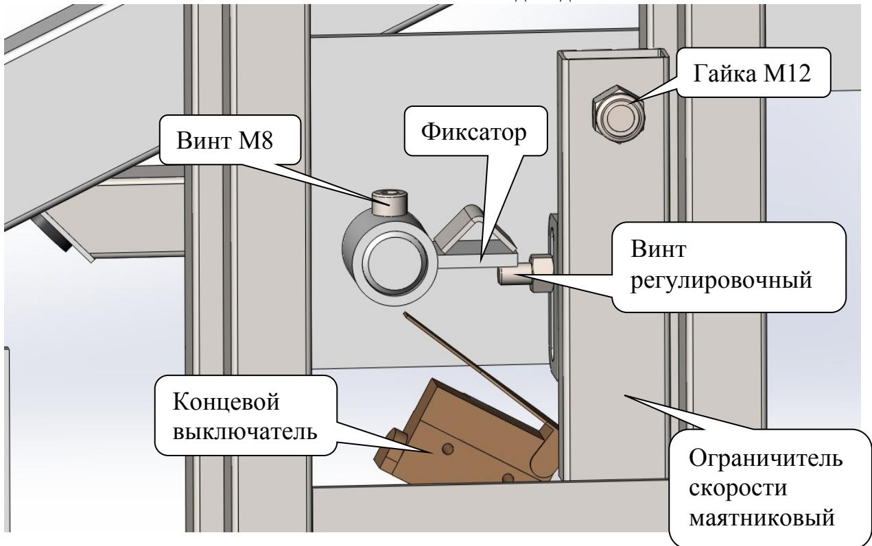
Установка ловителя – вид изнутри платформы. Рабочее положение
